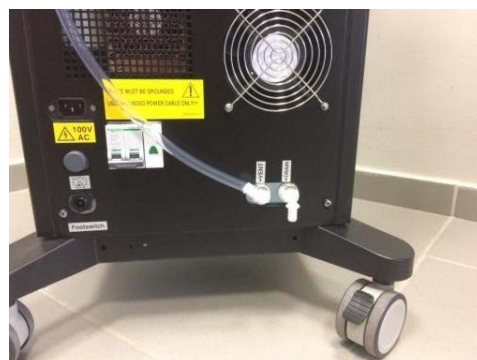
Figura 6-3: Drenar o refrigerante do reservatório
