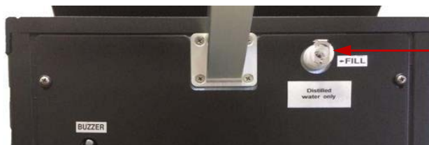
Figura 6-2: Porta de enchimento do reservatório de refrigerante no painel de serviço
