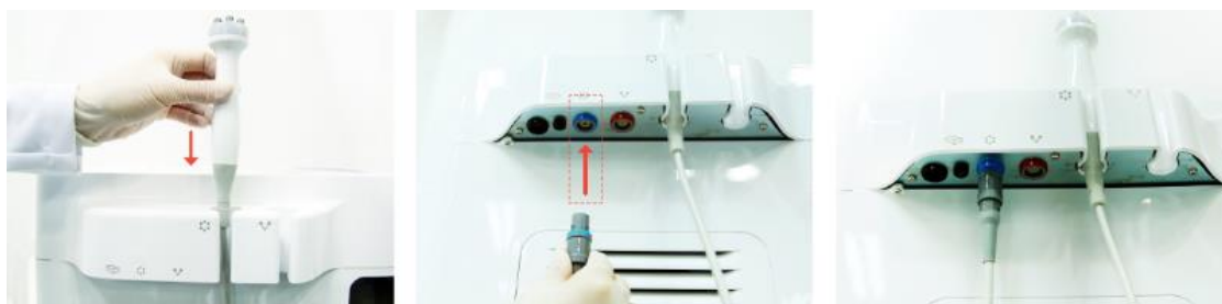
Figura 4.4 Conectando a Peça Manual de Eletroporação ao Corpo Principal
